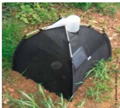
Tente à émergence pour capturer les insectes hivernant dans le sol et la végétation ainsi recouverts
